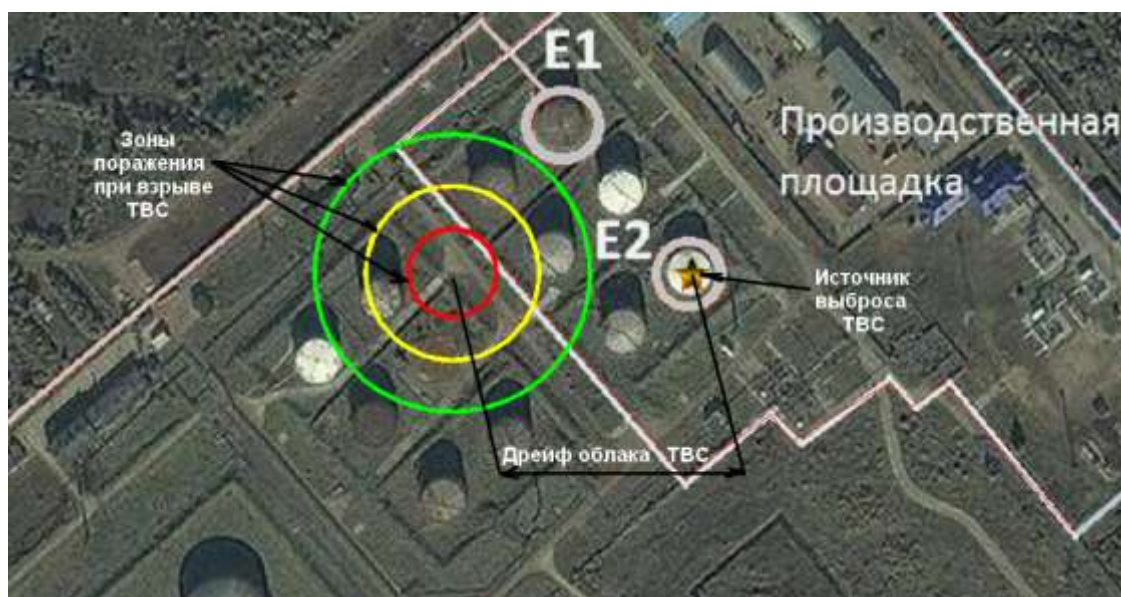
Рис. 3- 1. Зоны поражения ударной волной при взрыве облака ТВС
